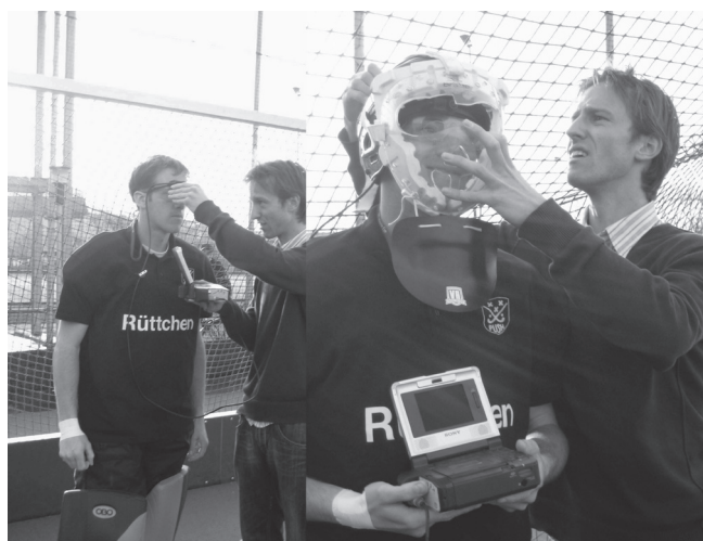
Figuur 1. Het kijkgedrag van de keeper werd onderzocht met de 'Mobile Eye'. Na het opzetten en kalibreren van deze speciale bril (links) wordt een masker opgezet om het apparaat te beschermen (rechts).
