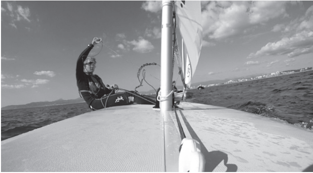
Figuur 1. Een zeiler vaart om de bovenwindse boei terwijl hij zijn trimmingslijnen losgooit. Op zijn hoofd draagt hij een eye tracker. De opname wordt opgeslagen op een recorder die zich bevindt in een waterdichte rugzak op zijn buik.
