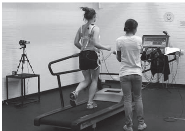
Figuur 1. Laboratoriumopstelling waarin met een 3D-analysesysteem de beweging van de borsten tijdens wandelen en hardlopen kan worden onderzocht (Overgenomen van de website van Breast Research Australia). 5
