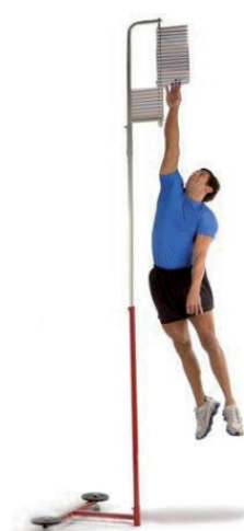
Figuur 2. Yardstick apparaat waarmee de spronghoogte (uit stand of uit aanloop) in een geïsoleerde testsituatie kan worden gemeten.
