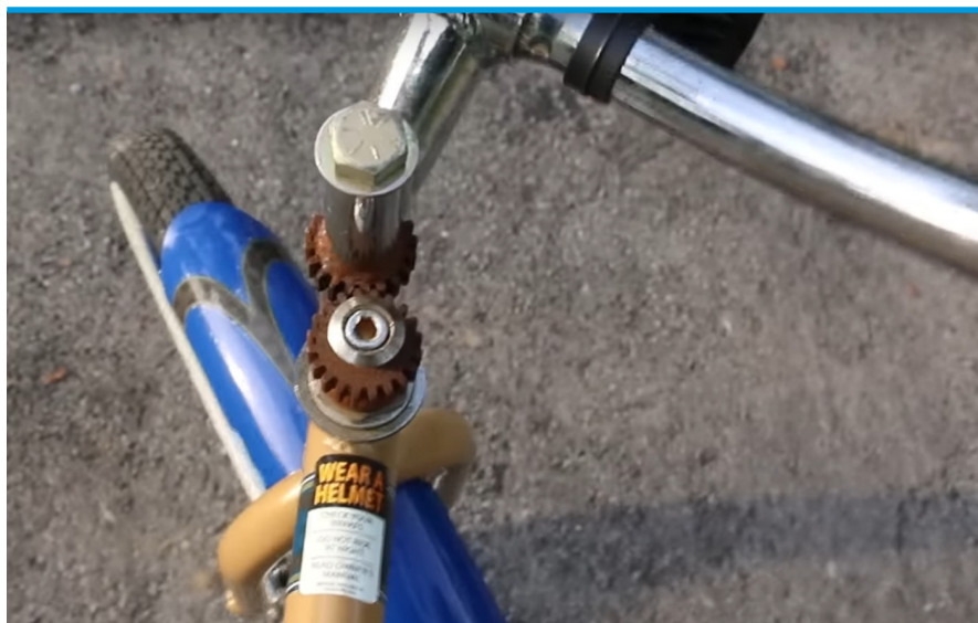
Figuur 2 | Het mechaniek van de omgekeerde fiets of 'backward (brain) bicycle'.
